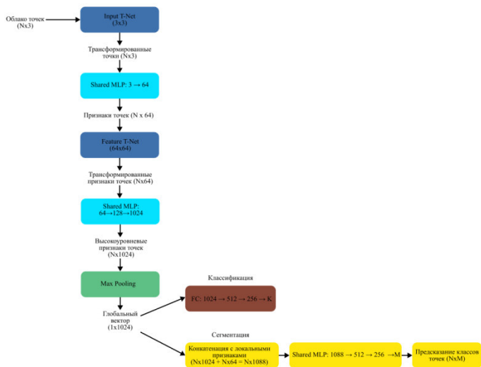
Рис. 2. Схема архитектуры PointNet
