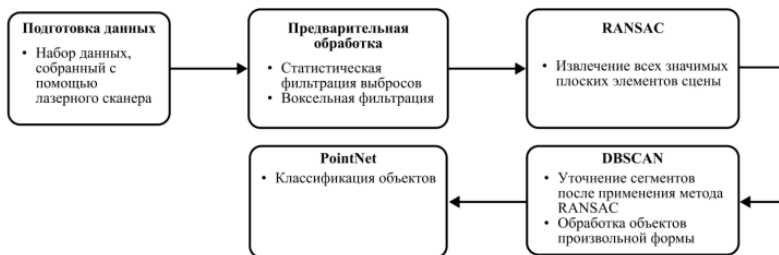
Рис. 3. Схема процесса обработки облака точек гибридным методом
